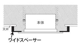
ワイドパネルとスペーサーが一体化した構造 天井の穴を塞ぎ天井面より機器を下げて 設置したいときお使いいただけます。
