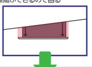
化粧パネルで隠しきれない隙間 がありさらに機器も天井面より 下げるのでその隙間を隠したい
